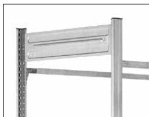
Aussteifungstraversen geben Stabilität und dienen auch zur Bodenaufgabe. Die Anzahl der Traversen richtet sich nach der Regalhöhe.
